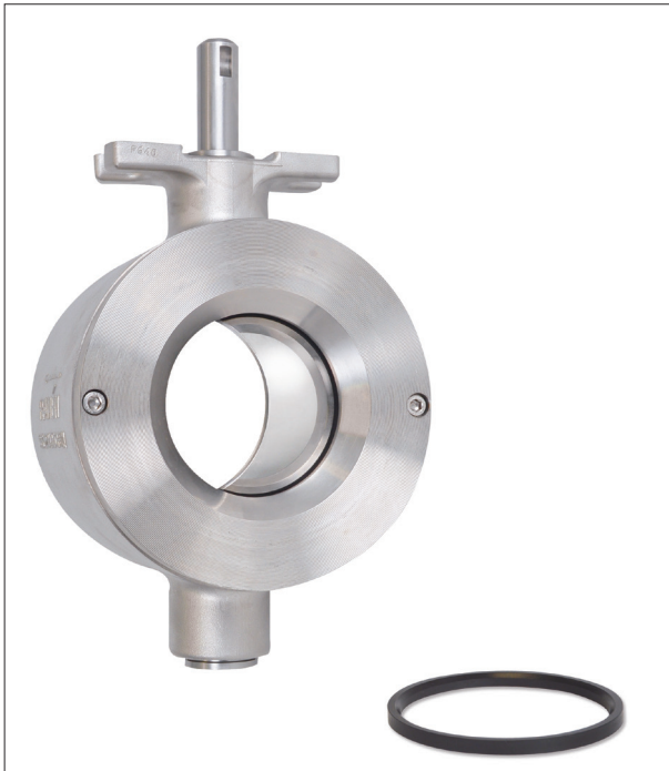
Ramén-KugelSektorventil Materialkombination 1 mit Sitzring aus PTFE (mit Kohle und Graphit gefüllt).
